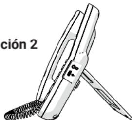
1. Alinee las patillas del soporte con las ranuras de la base y presione el soporte contra la base.
